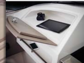
La sección de babor de la consola se ha aprovechado para incluir una guantera y un compartimento inferior con una toma de 12 V.
