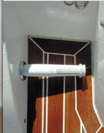
La ducha de popa queda instalada en el lateral de babor del pasillo que comunica la plataforma de baño con la bañera.
