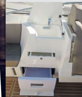
El wet bar centraliza su equipo principal, conformado por un fregadero moldeado y un cajón nevera, en el módulo instalado en babor.
