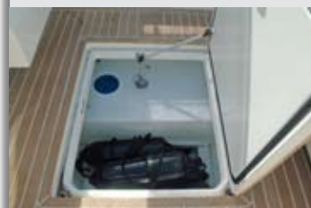
Un pistón a gas facilita la apertura del cofre situado en el suelo de la bañera, perfecto para las defensas u otros accesorios de a bordo.
