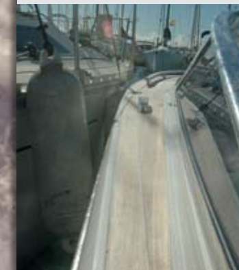
Los pasillos laterales se presentan como una prolongación de la cubierta de proa, estrechándose hacia popa y sin elementos de apoyo o protección.
